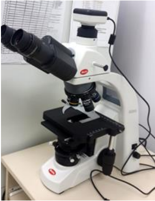
Figura 17. Microscópio óptico de luz invertida usado na contagem de UCF/campo do ensaio de adesão em CEB.
