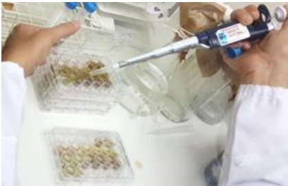
Figura 19. Pipetagem do extrato de erva mate para uma placa de 24 poços com corpos de prova em resina acrílica
